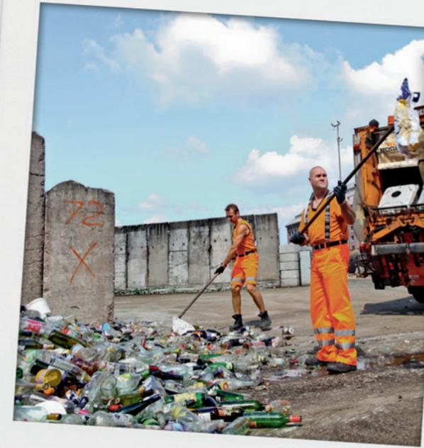
*Auf dem Hof der Glassortieranlage in Velten wird das Glas abgekippt. M&M sortieren die größten Plastikteile und Störstoffe heraus.*
