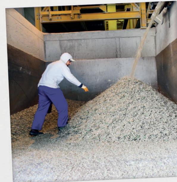
Nun ist die Flasche nur noch Scherben: Wie ein Wasserfall fließt das fertig gereinigte Glasgranulat von den Bändern. Fertig zum Abtransport.
