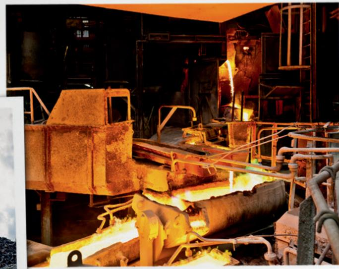
Bei Aurubis werden Platinumschluppsel mit Oxid geschmolzen und in Kathodenform gegossen.
