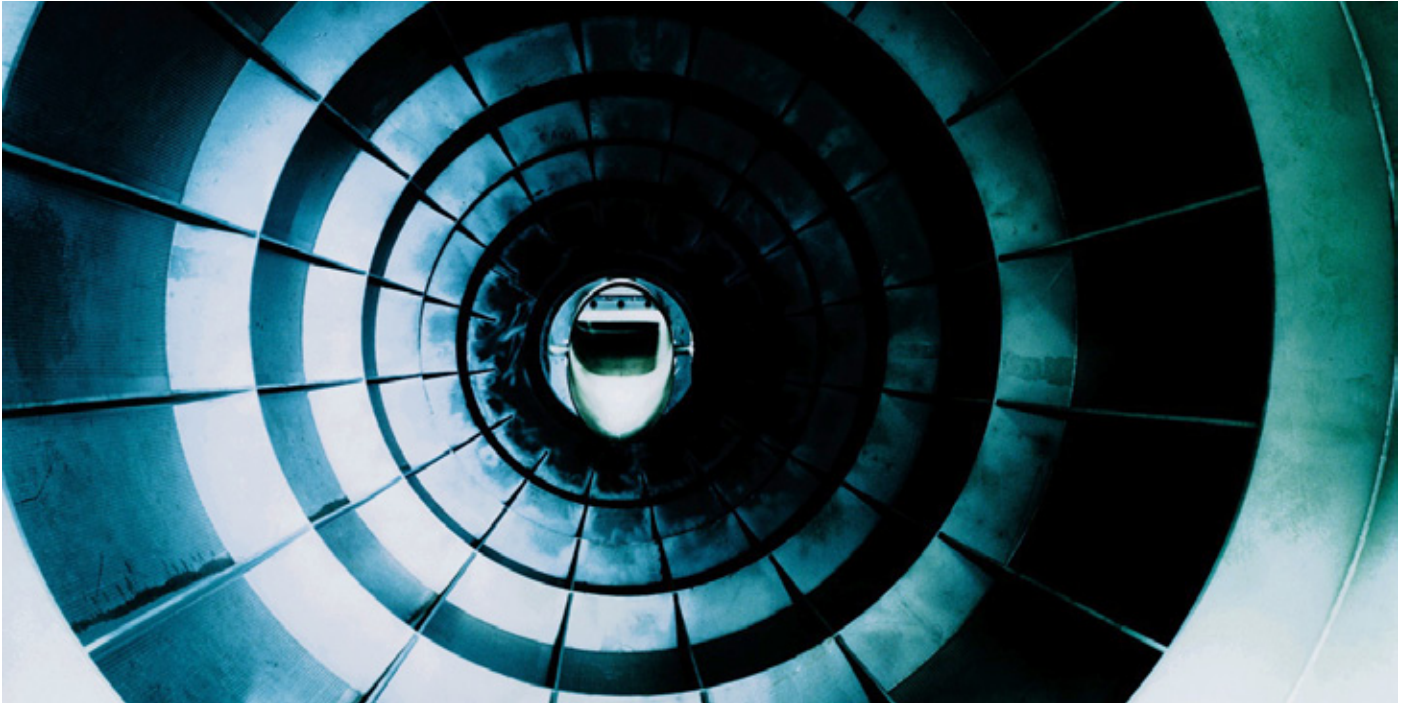
Innenansicht eines sog. Trommel-Pulpers
