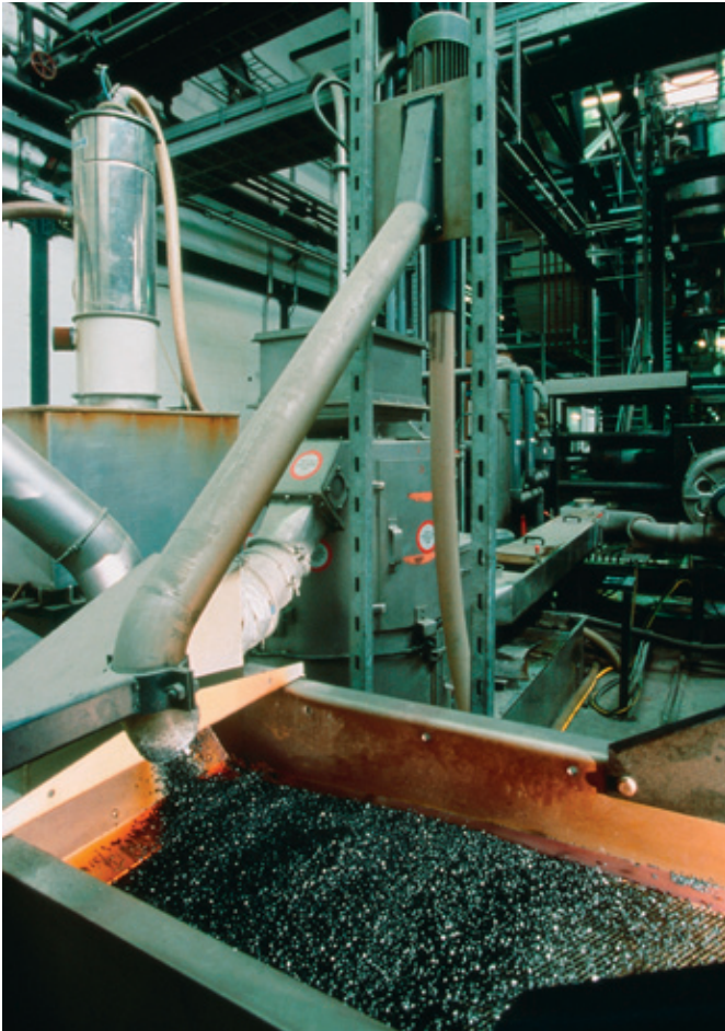
Über Rohrleitungen wird der Grundstoff in sogenannte Extruder eingeleitet. Dort wird das Material mittels beheizter Förderschnecken aufgeschmolzen, geknetet und verdichtet. Vollständig homogenisiert wird die entgaste Schmelze dann gefiltert, durch eine Lochscheibe gepresst und anschließend in millimeterdünne Scheibchen geschnitten, Ergebnis: ein hochreines Regranulat Foto: Copyright Der Grüne Punkt – Duales System Deutschland GmbH, Thomas Mayer
