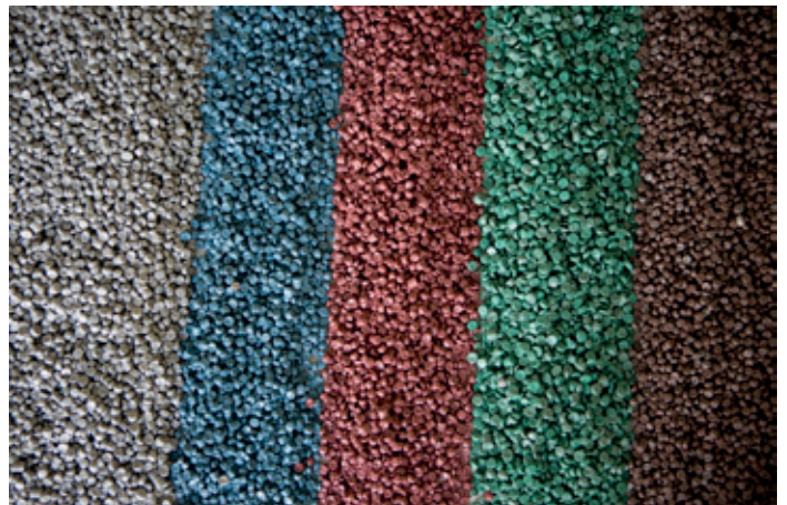
Bunte Regranulate aus Mischkunststoffen aus Polyethylen (meist Folien) und Polypropylen (meist Becher und Schalen) Foto: mtm plastics GmbH
