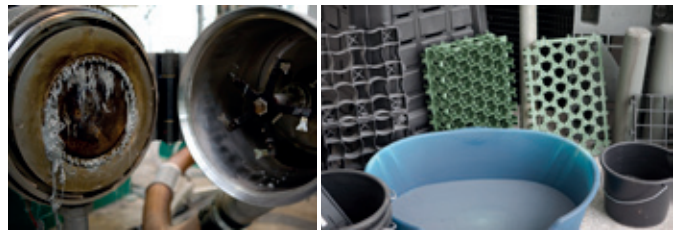
links: Schneidverdichter im Extruder, schneidet den Regranulatfaden zu kleinen Teilchen
