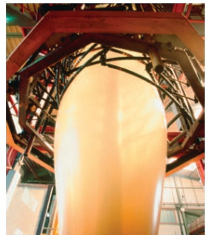
In Folienblasanlagen werden gebrauchte Polyethylen-Folien unter Hitzeeinwirkung vermengt, gedehnt und zu einem langen Schlauch geblasen.
